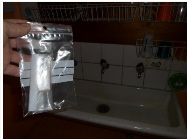
Composant : Colles des carrelages 45 (N) Colle de faïence Salle de classe 2
