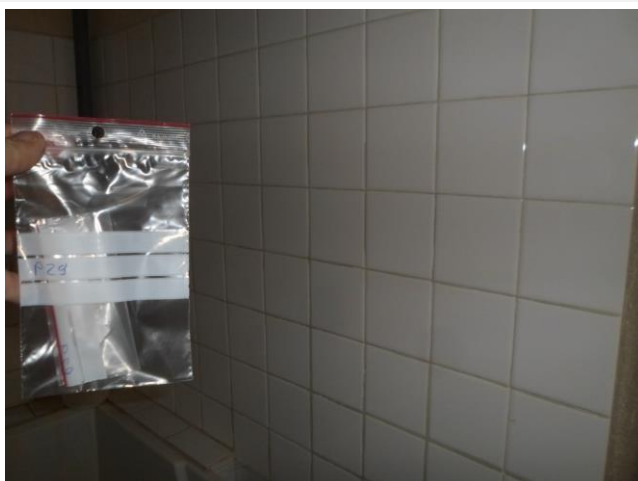
Composant : Colles des carrelages 36 (N) Colle de faïence 10x10 Sanitaire
