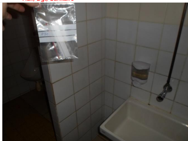
Composant : Colles des carrelages 37 (N) Colle de faïence 15x15 Sanitaire
