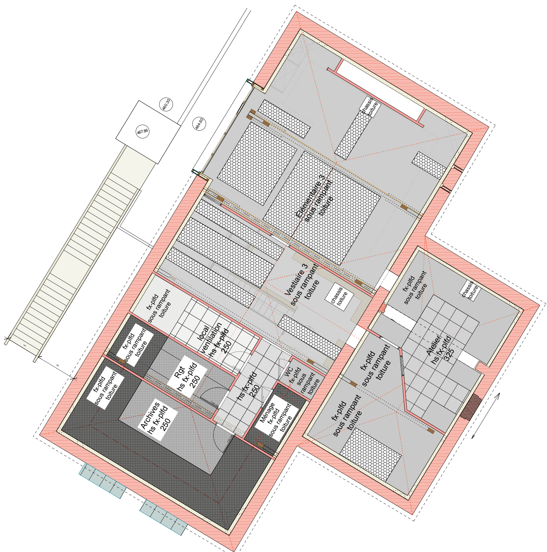
PLAN DES FAUX-PLAFONDS - R+2 - ÉCH. : 1/100 ème
