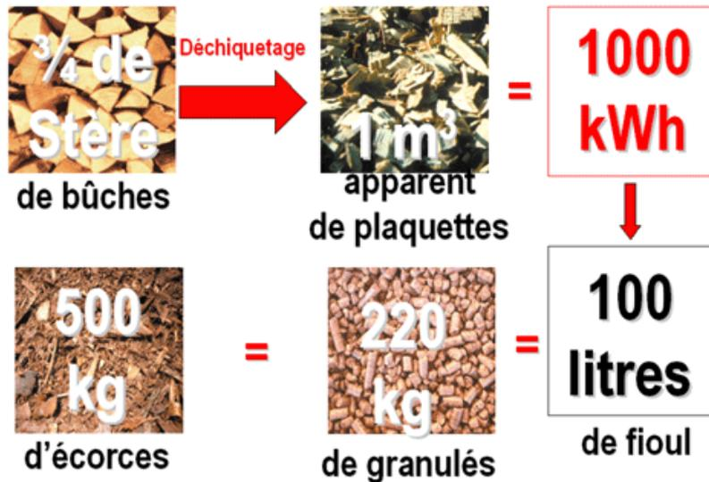
L'un des gros inconvénients du chauffage au bois par rapport aux autres énergies est qu'il nécessite plus de capacité de stockage. Avec cette petite équivalence énergétique, on constate par exemple qu'un mètre cube de bois déchiqueté donne approximativement la même quantité de chaleur que 100 litres de fuel, soit environ 1/10 de mètre cube.
